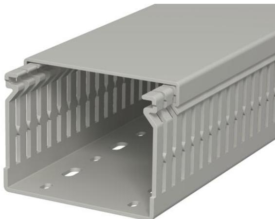
Verdrahtungskanal inkl. Oberteil und Bodenlochung zur waagerechten und senkrechten Verlegung elektrischer Kabel und Leitungen im Schaltschrank. Ausführung als metrischer Kanal. Das Nennmaß der Systemgröße entspricht dem Innenmaß der Kanäle. Das Ausbrechen der Stege erfolgt werkzeuglos. Bodenbündiges Ausführen ist durch Sollbruchstellen möglich. Verjüngungen in den Seitenschlitzen verhindern das Herausfallen der Leitungen. Geprüft nach DIN EN 50085-2-3. Sonderlängen auf Anfrage.
