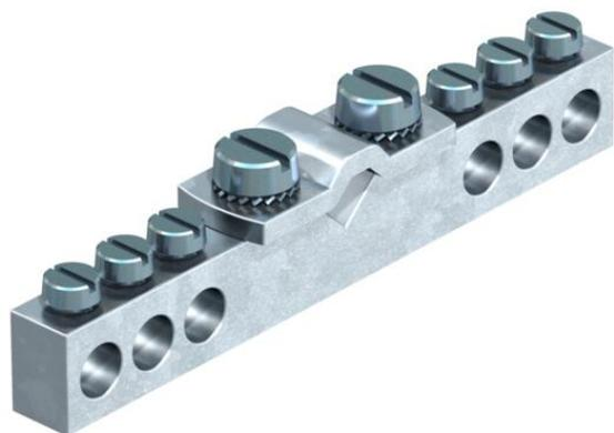
• Kontaktleiste aus Messing, vernickelt • Schrauben und Klemmbügel aus Stahl, galvanisch verzinkt Anschlussmöglichkeiten: • 6 Leitungen 1,5-10 mm<sup>2</sup> • 1 Leitung 6-16 mm<sup>2</sup>
