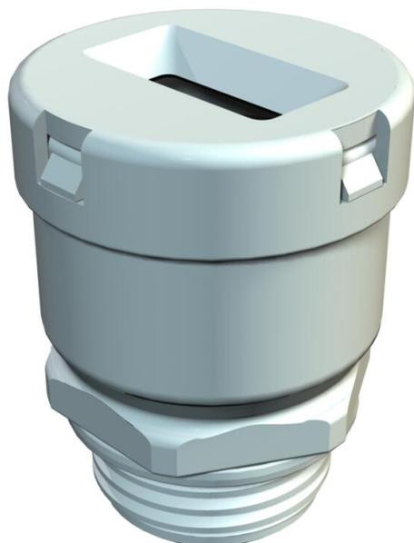
Flachkabeleinführung in Würgenippelbauart, mit metrischem Anschlussgewinde nach IEC 432, Schutzart IP 31, mit vormontiertem Stützendichtring 107/F.
