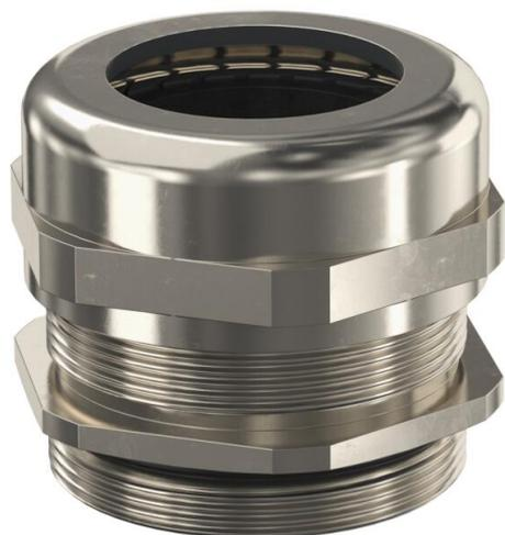
Robuste Kabelverschraubung mit metrischem Anschlussgewinde nach IEC 423 in Hutmutterbauart für hohe Dichtigkeitsansprüche. Zugentlastung, Verdreh-schutz und Dichtigkeit über den gesamten Spannbereich. Dichtring aus Neopren. Klemmeinsatz aus Polyamid. Mit vormontiertem Dichtring am Anschlussgewinde, VDE-geprüft nach DIN EN 50262, Schutzart IP68 bei 5 bar/1h, Temperaturein-satzbereich -20 bis +100°C.
