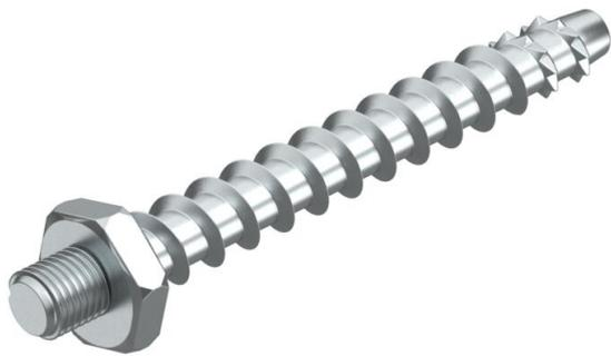
Schraubanker zur direkten Montage ohne Dübel in gerissenem und ungerissenem Beton sowie Mauerwerk. Anschlussgewinde M6 für die Befestigung von Schellen mit Gewindefuss.
