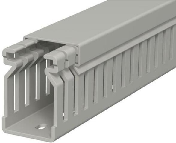
Verdrahtungskanal inkl. Oberteil und Bodenlochung zur waagerechten und senkrechten Verlegung elektrischer Kabel und Leitungen im Schaltschrank. Ausführung als metrischer Kanal. Das Nennmaß der Systemgröße entspricht dem Innenmaß der Kanäle. Das Ausbrechen der Stege erfolgt werkzeuglos. Bodenbündiges Ausführen ist durch Sollbruchstellen möglich. Geprüft nach DIN EN 50085-2-3. Sonderlängen auf Anfrage.
