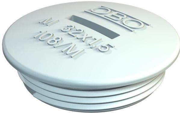
Verschlusschraube nach DIN 46320 mit metrischem Gewinde nach IEC 423. Schutzart IP54, IP68 (5 bar/1h) in Verbindung mit Dichtungsring Typ 171 möglich.
