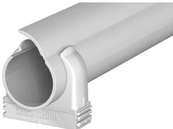
Set aus Elektroinstallationsrohren Quick-Pipe® und Aufputzschellen Quick-Schelle. Zum Aufputz-Verlegen von Kabel und Leitungen im Innen- und geschützten Außenbereich. Universelle Befestigung an Wand und Decke. Umfasst 30 m Rohr zu je 2 Meter Länge und 96 Quick-Schellen. Einsetzbar im Temperaturbereich von - 25° bis + 60° C.
