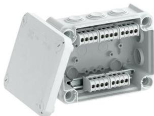
Kabelabzweigkasten mit Klemmleiste zum Verbinden von Kabeln und Leitungen im Innenbereich und geschützten Außenbereichen. Rechteckige Form mit Einsteckdichtungen an den Seiten und Ausschlageinführungen im Boden. Geeignet für die Wand-/ Deckenmontage und die Montage auf Montageblechen. Mit der Möglichkeit zur Innenbefestigung und Montage über die Eckdome. Deckel mit Schnellverschluss, plombierbar. Hergestellt aus halogenfreien und UV-resistenten Materialien.
