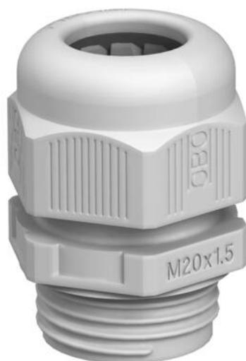
Die schnellste und bequemste Art mit Kabelverschraubungen an Kabelabzweigen und Gehäusen für Zugentlastung und Dichtigkeit zu sorgen: die bewährte V-TEC VM Kabelverschraubungen von OBO. Mit der integrierten Dichtlippe und speziellen OBO Lamellentechnik wird die Schutzklasse IP68 erreicht. Zugentlastung und Dichtigkeit sind geprüft nach DIN EN 62444.
