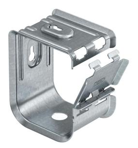
Sammelhalter aus Metall für hohe mechanische Standfestigkeit, auch im Brandfall. Zur sicheren Montage oberhalb von Brandschutzdecken geeignet. Auch als kabelspezifische Variante für den elektrischen Funktionserhalt nach DIN 4102 Teil 12 zugelassen. Für Wand- und Deckenmontage. Verschluss ohne Werkzeuge zu öffnen.
