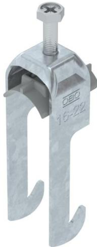
Bügelschelle mit W-Fuß, Kunststoffdruckwanne aus Polypropylen. Zur vertikalen und horizontalen Montage von 1 Einzelkabel an Winkeleisen bis < 40 mm. Mit 1-gängiger Schraube an Druckwanne, universeller Sechskant-Schraubenkopf SW10, mit Schlitz und Kreuzschlitz. Geeignet für Montage im Innen- und Außenbereich. Der Einsatz einer Gegenwanne wird empfohlen.
