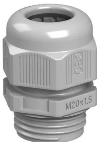
Kabelverschraubung mit metrischem Anschlussgewinde in Hutmutterbauart, für Kabelabzweiggkäten, Gehäuse, Verteilerkästen im privaten und industriellen Bereich. Mit Zugentlastung und integrierter Dichtlippe, geprüft nach DIN EN 62444. Schutzklasse IP68. Einsetzbar von -20°C bis +65°C.
