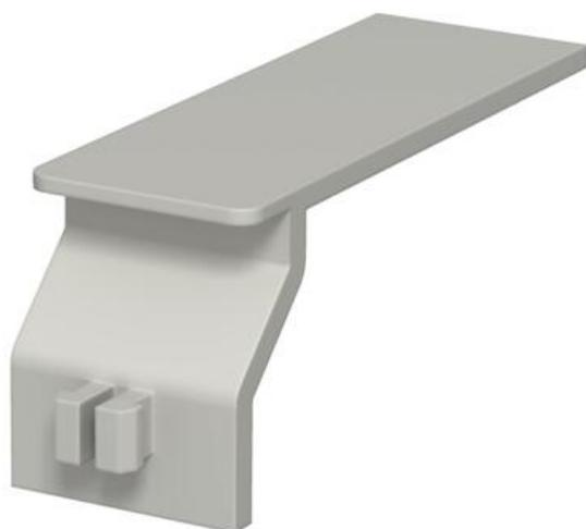
Drahthaltesteg für Verdrahtungskanäle Typ LK4 und LK4 N. Der Drahthaltesteg verhindert das Herausfallen bereits eingelegter Leitungen. Durch Sollbruchstellen ist die Länge für unterschiedliche Kanalbreiten reduzierbar auf 38, 28 und 23 mm.
