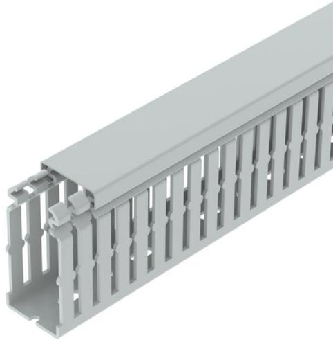
Halogenfreier Verdrahtungskanal nach DIN EN 50085-2-3 inkl. Oberteil und Bodenlochung zur waagerechten und senkrechten Verlegung elektrischer Kabel und Leitungen im Schaltschrank. Ausführung als DIN-Kanal. Das Ausbrechen der Stege erfolgt werkzeuglos. Bodenbündiges Ausführen ist durch Sollbruchstellen möglich. Verjüngungen in den Seitenschlitz verhindern das Herausfallen der Leitungen. Geprüft nach DIN EN 50085-2-3. Sonderlängen auf Anfrage.
