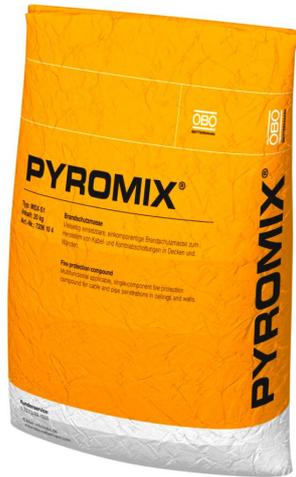
Mörtel zum Erstellen von Kabel- und Kombiabschottungen in massiven Wänden und Decken. Geeignet zum Pumpen, Pressen und zum Handeinbau. 20 kg Trockenmörtel ergeben bei Zugabe von ca. 6 Litern Wasser etwa 20 Liter verarbeitungsfähige Masse. Anwendung im Innenbereich. In trockenen, kühlen aber frostfreien Räumen kann der Trockenmörtel mindestens 12 Monate in verschlossenen Originalgebinden gelagert werden.
