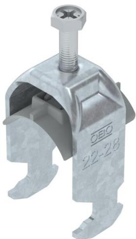
Bügel­schelle mit Hammerkopf-Fuß, Kunststoffdruckwanne aus Polypropylen. Zur vertikalen und horizontalen Montage von 1 Einzelkabel an C-Profil­schiene. Für Schlitzweite 16 - 17 mm. Mit 1-gängiger Schraube an Druckwanne, universeller Sechskant-Schraubenkopf SW10, mit Schlitz und Kreuzschlitz. Geeignet für Montage im Innen- und Außenbereich. Der Einsatz einer Gegenwanne wird empfohlen.
