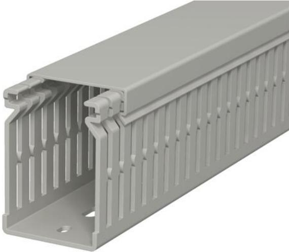
Verdrahtungskanal inkl. Oberteil und Bodenlochung zur waagerechten und senkrechten Verlegung elektrischer Kabel und Leitungen im Schaltschrank. Ausführung als metrischer Kanal. Das Nennmaß der Systemgröße entspricht dem Innenmaß der Kanäle. Das Ausbrechen der Stege erfolgt werkzeuglos. Bodenbündiges Ausführen ist durch Sollbruchstellen möglich. Verjüngungen in den Seitenschlitz verhindern das Herausfallen der Leitungen. Geprüft nach DIN EN 50085-2-3. Sonderlängen auf Anfrage.
