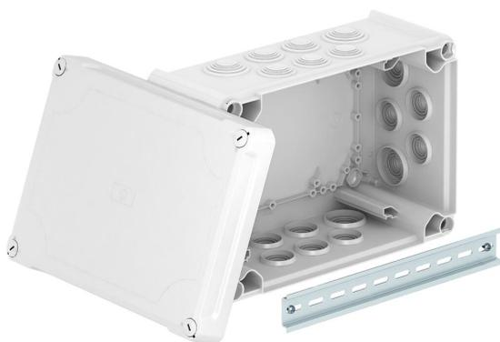
Kabelabzweigkasten zum Verbinden von Kabeln und Leitungen im Innenbereich und geschützten Außenbereichen. Rechteckige Form mit Einsteckdichtungen. Geeignet für die Wand-/ Deckenmontage, die Montage auf Montageblechen und Gewinde im Boden. Mit der Möglichkeit zur Innenbefestigung und Montage über die Eckdome. Hoher Deckel mit Schnellverschluss, plombierbar. Hergestellt aus halogenfreien und UV-resistenten Materialien.
