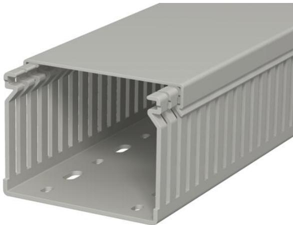
Verdrahtungskanal inkl. Oberteil und Bodenlochung zur waagerechten und senkrechten Verlegung elektrischer Kabel und Leitungen im Schaltschrank. Ausführung als metrischer Kanal. Das Nennmaß der Systemgröße entspricht dem Innenmaß der Kanäle. Das Ausbrechen der Stege erfolgt werkzeuglos. Bodenbündiges Ausführen ist durch Sollbruchstellen möglich. Geprüft nach DIN EN 50085-2-3. Sonderlängen auf Anfrage.
