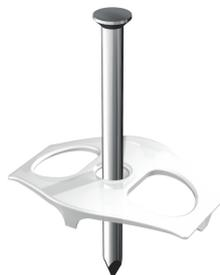
Mit vormontiertem, verzinkten Stahlnagel  $\varnothing$  3 mm oder 3,5 mm zur Fixierung von Leitungen in Mauerschlitzen und auf Mauerwerk für 1 bzw. 2 Leitungen NYM 3 x 1,5/2,5 mm<sup>2</sup> oder 1 bzw. 2 Leitungen NYM 5 x 1,5/2,5 mm<sup>2</sup>.
