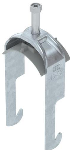
Bügelschelle mit W-Fuß, Kunststoffdruckwanne aus Polypropylen. Zur vertikalen und horizontalen Montage von 1 Einzelkabel an Winkeleisen bis < 40 mm. Mit 1-gängiger Schraube an Druckwanne, universeller Sechskant-Schraubenkopf SW10, mit Schlitz und Kreuzschlitz. Geeignet für Montage im Innen- und Außenbereich. Der Einsatz einer Gegenwanne wird empfohlen.
