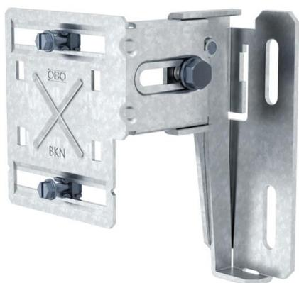
Befestigungskonsolle zur Montage von Geräteeinbaukanälen an Brüstungskonstruktionen und als Auflage für Konvektionsgitter. Die Befestigungskonsolle ist für alle Rapid 80 Geräteeinbaukanalsysteme vom Typ GK und GA einsetzbar. Für die Montage von GK Geräteeinbaukanälen aus Kunststoff wird zusätzlich der passende Wandkonsolenadapter benötigt. Für die Montage von Doppelkanälen Typ GS-D70170 und GS-D90170 sowie für GS Kanäle mit 210 mm Nennbreite wird das Verbindungsprofil benötigt.
