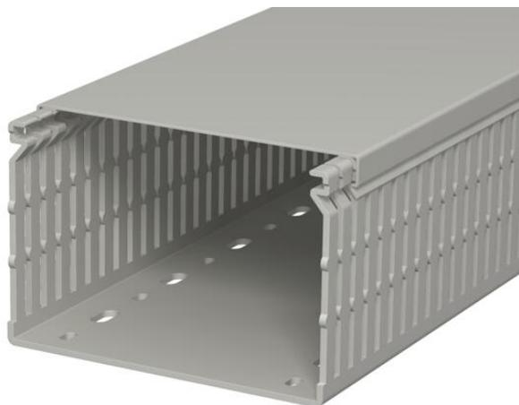
Verdrahtungskanal inkl. Oberteil und Bodenlochung zur waagerechten und senkrechten Verlegung elektrischer Kabel und Leitungen im Schaltschrank. Ausführung als metrischer Kanal. Das Nennmaß der Systemgröße entspricht dem Innenmaß der Kanäle. Das Ausbrechen der Stege erfolgt werkzeuglos. Bodenbündiges Ausführen ist durch Sollbruchstellen möglich. Verjüngungen in den Seitenschlitz verhindern das Herausfallen der Leitungen. Geprüft nach DIN EN 50085-2-3. Sonderlängen auf Anfrage.
