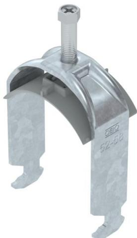
Bügelschelle mit Hammerkopf-Fuß, Kunststoffdruckwanne aus Polypropylen. Zur vertikalen und horizontalen Montage von 1 Einzelkabel an C-Profileschiene. Für Schlitzweite 16 - 17 mm. Mit 1-gängiger Schraube an Druckwanne, universeller Sechskant-Schraubenkopf SW10, mit Schlitz und Kreuzschlitz. Geeignet für Montage im Innen- und Außenbereich. Der Einsatz einer Gegenwanne wird empfohlen.
