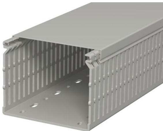
Verdrahtungskanal inkl. Oberteil und Bodenlechung zur waagerechten und senkrechten Verlegung elektrischer Kabel und Leitungen im Schaltschrank. Ausführung als metrischer Kanal. Das Nennmaß der Systemgröße entspricht dem Innenmaß der Kanäle. Das Ausbrechen der Stege erfolgt werkzeuglos. Bodenbündiges Ausführen ist durch Sollbruchstellen möglich. Verjüngungen in den Seitenschlitz verhindern das Herausfallen der Leitungen. Geprüft nach DIN EN 50085-2-3. Sonderlängen auf Anfrage.
