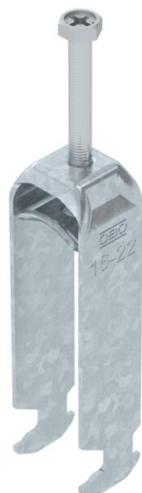
Bügelshelle mit Hammerkopf-Fuß, Metalldruckwanne mit gerundeten Kanten für Kabelschutz. Zur vertikalen und horizontalen Montage von 3 Einzelkabeln an C-Profilschiene. Für Schlitzweite 16 - 17 mm. Mit 1-gängiger Schraube an Druckwanne, universeller Sechskant-Schraubenkopf SW10, mit Schlitz und Kreuzschlitz. Geeignet für Montage im Innen- und Außenbereich. Mehrere Kabel sollten durch Doppelwannen getrennt werden. Der Einsatz einer Gegenwanne wird empfohlen.
