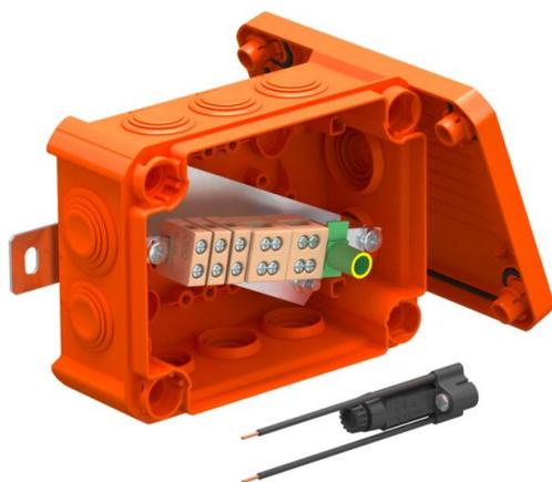
Kabelabzweigkasten mit einem Sicherungshalter und weichen Einsteckdichtungen. Ausreichender Verdrahtungsraum durch diagonal angeordnete Anschlusseinheit mit komplett vormontierten hochtemperaturbeständigen Keramikklappen. Grün-gelb gekennzeichnete Schutzleiterklemme. Befestigung an gut zugänglichen Außenlaschen. Zugelassen für Kabelanlagen mit elektrischem Funktionserhalt nach DIN 4102 Teil 12 mit den Klassen E30, E60 und E90. Keramikklappen wurden nach DIN EN 60998-2-1:2004 geprüft.
