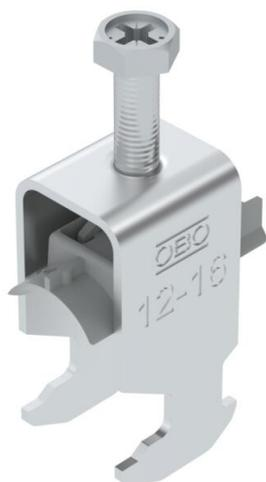
Bügel­schelle mit Hammerkopf-Fuß, Kunststoffdruckwanne aus Polypropylen. Zur vertikalen und horizontalen Montage von 1 Einzelkabel an C-Profileschiene. Für Schlitzweite 16 - 17 mm. Mit 1-gängiger Schraube an Druckwanne, universeller Sechskant-Schraubenkopf SW10, mit Schlitz und Kreuzschlitz. Geeignet für Montage im Innen- und Außenbereich. Der Einsatz einer Gegenwanne wird empfohlen.
