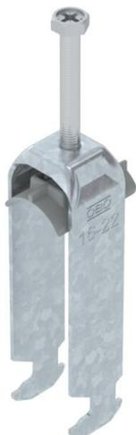
Bügel­schelle mit Hammerkopf-Fuß, Kunststoffdruckwanne aus Polypropylen. Zur vertikalen und horizontalen Montage von 3 Einzelkabeln an C-Profil­schiene. Für Schlitzweite 16 - 17 mm. Mit 1-gängiger Schraube an Druckwanne, universeller Sechskant-Schraubenkopf SW10, mit Schlitz und Kreuzschlitz. Geeignet für Montage im Innen- und Außenbereich. Mehrere Kabel sollten durch Doppelwan­nen getrennt werden. Der Einsatz einer Gegenwanne wird empfohlen.
