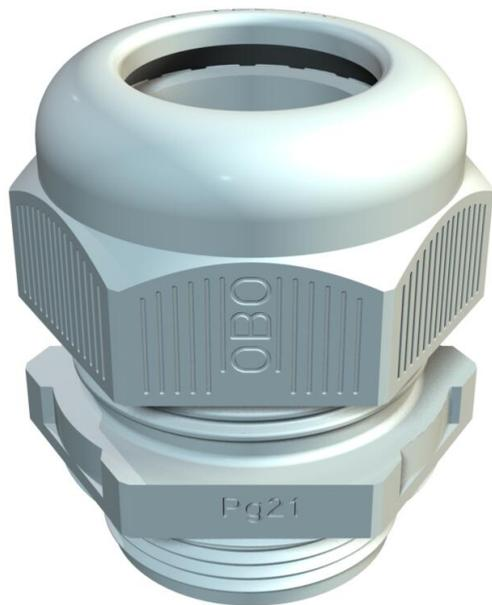
Kabelverschraubung mit PG-Anschlussgewinde in Hutmutterbauart, für Kabelabzweiggästen, Gehäuse, Verteilerkästen im privaten und industriellen Bereich. Mit Zugentlastung und integrierter Dichtlippe, geprüft nach DIN EN 62444. Schutzklasse IP68. Einsetzbar von -20°C bis +65°C.
