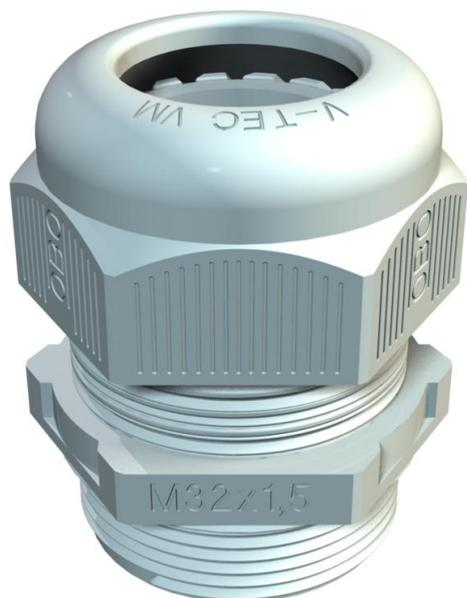
Kabelverschraubung mit metrischem Anschlussgewinde in Hutmutterbauart, für Kabelabzweigkästen, Gehäuse, Verteilerkästen im privaten und industriellen Bereich. Mit Zugentlastung und integrierter Dichtlippe, geprüft nach DIN EN 62444. Schutzklasse IP68. Einsetzbar von -20°C bis +65°C.
