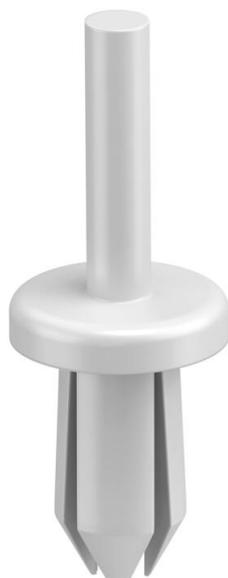
Für eine schnelle Montage und zur optimalen Funktion ist das Nietwerkzeug KNW2 zu verwenden. Maß des Bohrloches: 6,5 mm.
