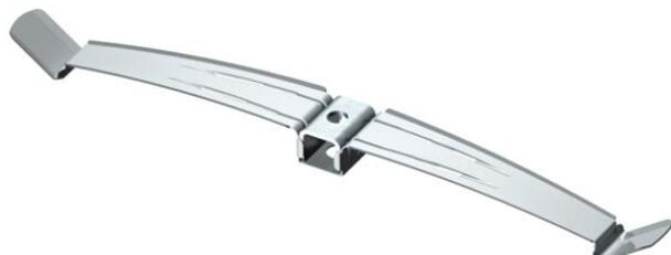
Die Kabelklammer aus Metall ist halogen- und brandlastfrei und bietet auch im Brandfall hohe mechanische Standfestigkeit. Die Kabelklammer ist als kabelspezifische Variante für den elektrischen Funktionserhalt gem. DIN 4102 Teil 12 zugelassen. Das Distanzstück 2033 D 15 x 3 G (separat zu bestellen) vergrößert bei Kabelklammern die Klemmhöhe von 10 auf 13 mm. Die Kabelklammer eignet sich zur brandsicheren Montage oberhalb abgehängter Brandschutzdecken nach DIN 4102.
