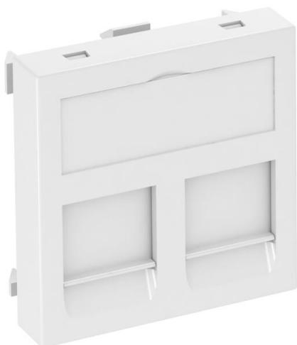
Datentechnikträger mit geradem Auslass und Verschlussschieber zur Aufnahme von zwei Datentechnik-Anschlussmodulen mit RJ45-Buchse. Die Rastbefestigung eignet sich für den waagerechten und senkrechten Einbau in die Systemumgebung. Typ B hat eine Montageöffnung von 19,35/21,55 X 14,85 mm und ist für die direkte Befestigung der Daten-Anschlussmodule in der Montageöffnung ausgelegt.
