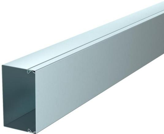
Kanaloberteil und -unterteil mit Bodenlochung. Der Potentialausgleich ist ohne weitere Hilfsmittel zwischen Unter- und Oberteil gewährleistet. Der LKM Leitungsführungskanal Typ LKM 60100 ist als Verlegesystem für Funktionserhalt nach DIN 4102 Teil 12 geprüft. Bitte beachten Sie die im Bereich BSS Brand-schutz-Systeme geprüften Kabeltypen! Auf dem Boden ist eine Schlaufenlochung, die zur Aufnahme der Trennwand dient.
