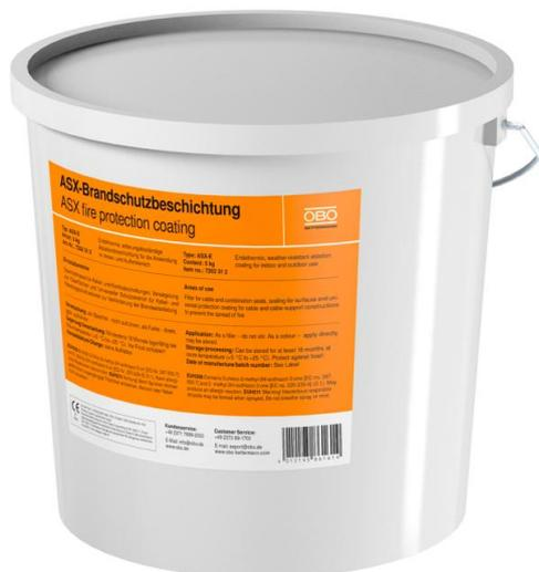
Kombinierte, endotherme und witterungsbeständige Beschichtung für den Innen- und Außenbereich. Universeller Schutzanstrich für Kabel- und Kabeltragekonstruktionen. Anwendung als Spachtel direkt, als Farbe durch Aufrühren. Ausreichend für eine Fläche von 4 m<sup>2</sup>. Baustoffklasse DIN 4102 - B2 normal entflammbar. In trockenen, frostfreien Räumen kann die Beschichtung bei Temperaturen von +5 °C bis +25 °C bis zu 18 Monate in verschlossenen Originalgebinden stehend gelagert werden.
