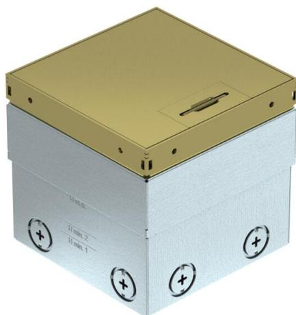
Quadratische Bodensteckdose für den Einsatz in trocken gepflegten Holzböden und Estrichböden. Einbaugehäuse mit vorgeprägten Einführungsöffnungen für Rohre (M20/M25). Oberteil durch 4 Nivellierstützen auf Oberkante Bodenbelag einstellbar. Die Mindesteinbautiefe beträgt 100 mm, der Nivellierbereich + 35 mm.
