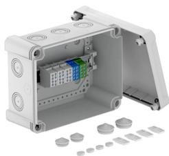
Kabelabzweigkasten zum Verbinden von Kabeln und Leitungen im Innen- und Außenbereich. Rechteckige Form mit Ausschlageinführungen. Geeignet für die Wand-/ Deckenmontage mit der Möglichkeit zur Außenbefestigung, Innenbefestigung oder Montage über die Eckdome. Besonders schlagfest mit IK09. Deckel mit Schnellverschluss, plombierbar. Hergestellt aus halogenfreien und UV-resistenten Materialien.
