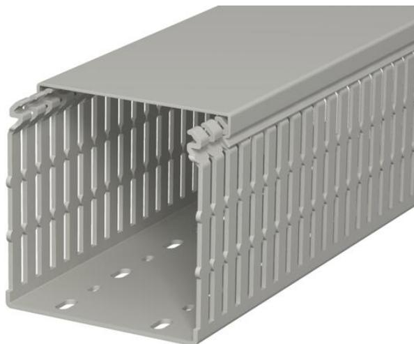
Verdrahtungskanal nach DIN EN 50085-2-3 inkl. Oberteil und Bodenlochung zur waagerechten und senkrechten Verlegung elektrischer Kabel und Leitungen im Schaltschrank. Ausführung als DIN-Kanal. Das Ausbrechen der Stege erfolgt werkzeuglos. Bodenbündiges Ausführen ist durch Sollbruchstellen möglich. Verjüngungen in den Seitenschlitzen verhindern das Herausfallen der Leitungen. Geprüft nach DIN EN 50085-2-3. Sonderlängen auf Anfrage.
