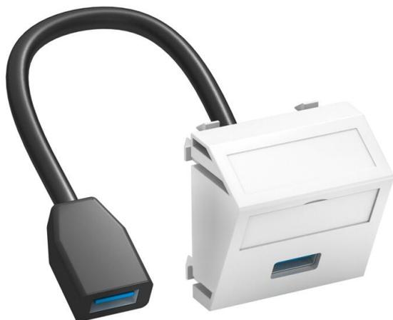
Multimediaträger mit einer USB 3.0-Anschlussbuchse, Kabelauslass schräg, mit Beschriftungsfeld, kurzes USB 3.0 Typ A-Anschlusskabel in Ausführung Buchse-Buchse. Trägerplatte mit Rastbefestigung, geeignet für den waagerechten und senkrechten Einbau in die Systemumgebung.
