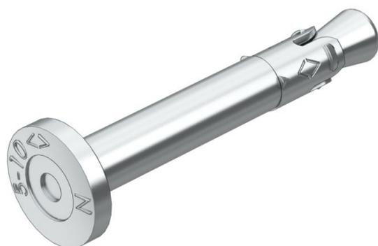
Der Nagelanker N-K ist einsetzbar für Mehrfachbefestigungen nichttragender Systeme in gerissenen und ungerissenen Beton und verbindet die Vorteile eines Bolzenankers mit einer noch einfacheren Montage.
