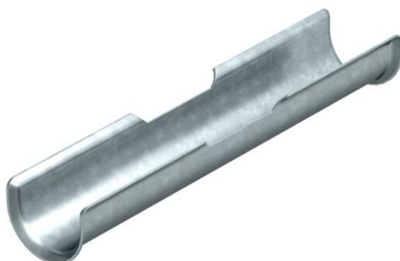
Zur Vergrößerung der Auflagefläche für Kabel mit integriertem Funktionserhalt wird zusätzlich zur Bügelschelle noch eine Langwanne (L = 200 mm) montiert.
