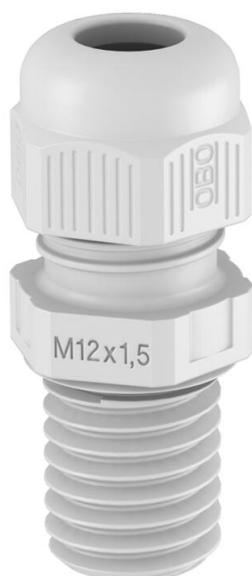
Kabelverschraubung mit metrischem Anschlussgewinde in Hutmutterbauart, für Kabelabzweiggästen, Gehäuse, Verteilerschränke im privaten und industriellen Bereich. Mit Zugentlastung und integrierter Dichtlippe, geprüft nach DIN EN 62444. Schutzklasse IP68. Einsetzbar von -20°C bis +65°C.
