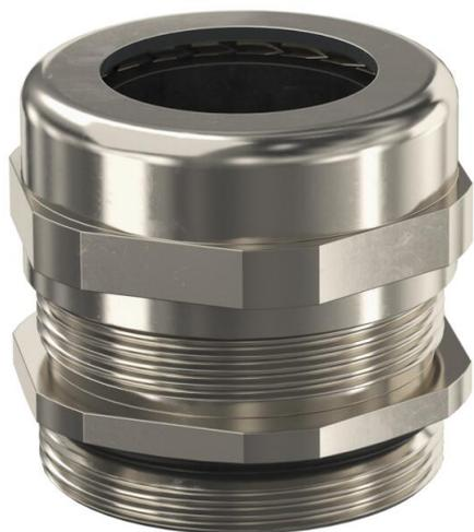
Robuste Kabelverschraubung mit metrischem Anschlussgewinde nach IEC 423 in Hutmutterbauart für hohe Dichtigkeitsansprüche. Zugentlastung, Verdreh-schutz und Dichtigkeit über den gesamten Spannbereich. Dichtring aus Neopren. Klemmeinsatz aus Polyamid. Mit vormontiertem Dichtring am Anschlussgewinde, VDE-geprüft nach DIN EN 50262, Schutzart IP68 bei 5 bar/1h, Temperaturein-satzbereich -20 bis +100°C.
