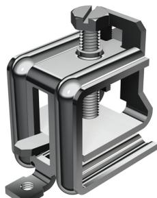
Zur schnellen Befestigung an Stahlprofilen bei der Montage von Kabelbahnen, Bügelschellen, Leuchtaufhängungen usw. Ein komplettes System besteht aus 2 Trägerklammern und einem Stück C-Profilschiene beliebiger Länge, sowie 2 Schutzkappen.
