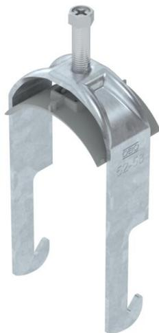
Bügelschelle mit W-Fuß, Kunststoffdruckwanne aus Polypropylen. Zur vertikalen und horizontalen Montage von 1 Einzelkabel an Winkeleisen bis < 40 mm. Mit 1-gängiger Schraube an Druckwanne, universeller Sechskant-Schraubkopf SW10, mit Schlitz und Kreuzschlitz. Geeignet für Montage im Innen- und Außenbereich. Der Einsatz einer Gegenwanne wird empfohlen.
