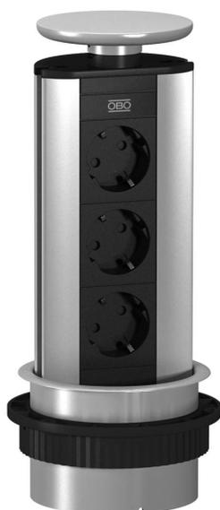
Versenkbare Deskbox mit Anschlusskabel, für den festen Einbau in eine Tischplatte, Befestigungsmanschette aus Kunststoff, passend lackiert in Deckelfarben. Die Montage erfolgt über eine Bohrung ( $\varnothing 102$  mm) in der Tischplatte. Bestückung: - drei schwarze Schutzkontakt-Steckdosen in 60°-Steckrichtung, inkl. 3,0 m Netzkabel mit Winkelstecker CEE 7/7. Hinweis: Einsetzbar in Tischplatten bis maximal 50 mm Stärke.
