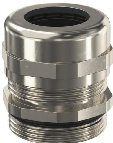
Robuste Kabelverschraubung mit metrischem Anschlussgewinde nach IEC 423 in Hutmutterbauart für hohe Dichtigkeitsansprüche. Zugentlastung, Verdreh-schutz und Dichtigkeit über den gesamten Spannbereich. Dichtring aus Neopren. Klemmeinsatz aus Polyamid. Mit vormontiertem Dichtring am Anschlussgewinde, VDE-geprüft nach DIN EN 50262, Schutzart IP68 bei 5 bar/1h, Temperaturein-satzbereich -20 bis +100°C.
