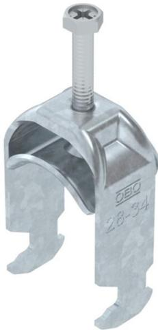
Bügelshelle mit Hammerkopf-Fuß, Metalldruckwanne mit gerundeten Kanten für Kabelschutz. Zur vertikalen und horizontalen Montage von 1 Einzelkabel an C-Profilshiene. Für Schlitzweite 16 - 17 mm. Mit 1-gängiger Schraube an Druckwanne, universeller Sechskant-Schraubenkopf SW10, mit Schlitz und Kreuzschlitz. Geeignet für Montage im Innen- und Außenbereich. Gegenwanne muss separat bestellt werden.
